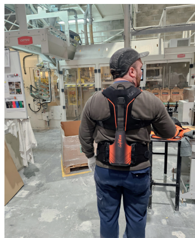
Les exosquelettes permettent aux collaborateurs Beissier de s'affranchir de la manipulation répétitive de charges lourdes.
